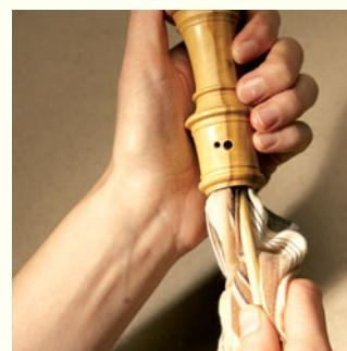
Blockflötenklappen müssen geschützt werden, denn weder die Polster noch die Mechanik selbst dürfen mit dem Öl in Berührung kommen. Die verwendeten pflanzlichen Öle härteten aus und würden die Beweglichkeit der Klappe beeinträchtigen. Deshalb schieben Sie ein zusammengefaltetes Stück Frischhaltefolie zwischen Tonloch und Klappenpolster, damit kein Öl aus der Bohrung heraus an die Klappe dringen kann. Die Flötenteile stets so halten, dass die Klappen nach oben schauen!
