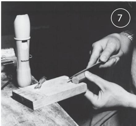
Nun wird die Blockbahn bearbeitet, deren Höhe sich nach dem Verwendungszweck des Instruments richtet (7). Bei Schulflöten, die vor allem von Kindern gespielt werden, wird aus Gründen des stärkeren Speichelflusses der Windkanal so konstruiert, dass etwa ein Viertel des Kanalquerschnitts unterhalb der Labiumkante verläuft. Bei Flöten für anspruchsvolle Spieler hingegen lässt man die Blockbahn so hoch, dass sie annähernd mit der Labiumkante auf einer Ebene liegt (8).
